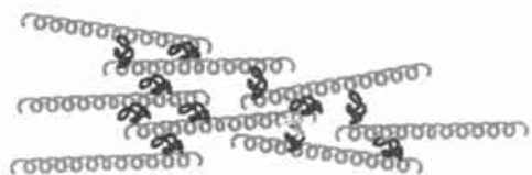
图 9 \alpha 螺旋多肽与相反电荷的聚电解质无规线团相连接的示意图 [18]
