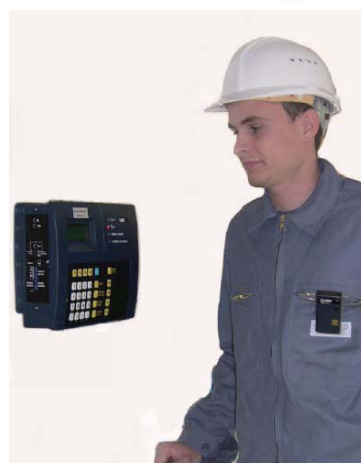
技术人员使用免提功能的 DMC 2000 S与LDM 2000读出器。
