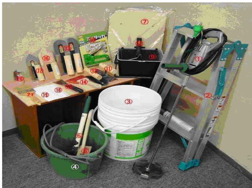
◆硅藻泥施工工具——无论是那种肌理的施工，最低限度要有：
